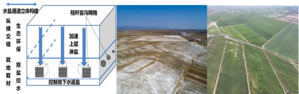
（从左至右依次为盲沟立体排盐技术示意图、盐碱地改良前和改良后效果图） 节水控盐与生态治理的“鄂尔多斯模式”突破了空心盲沟易坍塌、不耐用、效果不稳定的瓶颈问题
